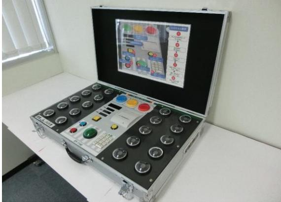
計20個のランプの内、ランダムで左側2ヶ所のランプが点灯。そのランプを同時に押さえると、今度は右のランプが2ヶ所点灯。20回押さえるまでの時間を計測します。
